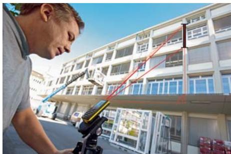
Indirekte Höhenmessung: Fensterhöhen mittels Pythagorasfunktion bestimmen.
