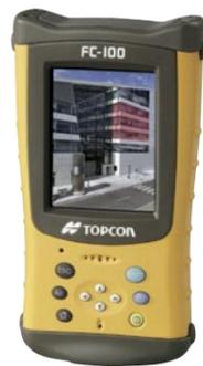
Die neue Field-Scan Software auf dem FC-100 macht aus den Totalstationen der GPT-8200A Serie einen Scanner für die Aufnahme von Fassaden oder anderen Objekten. Diese Lösung versetzt jeden Ingenieur in die Lage mit seinem Instrument mit dem er seinen täglichen Job erledigt, auch Scan-Aufträge erledigen.
